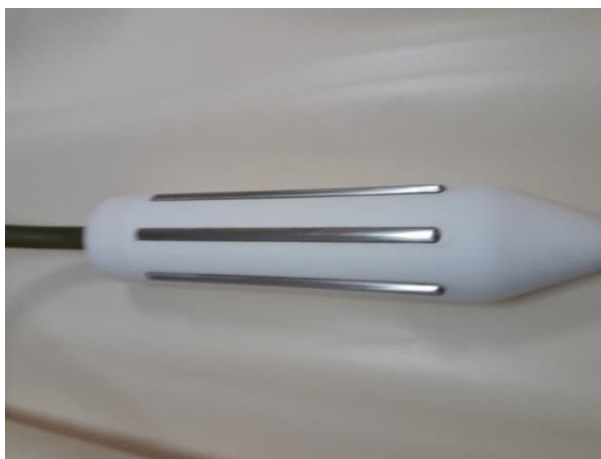
Fig. 3 - Sonda com eletrodos longitudinais paralelos.
